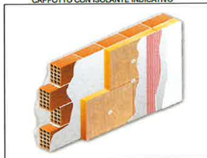
SCHEMA ESEMPLIFICATIVO INTERVENTO CAPPOTTO CON ISOLANTE INDICATIVO
