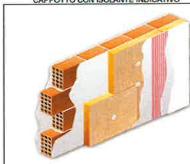
SCHEMA ESEMPLIFICATIVO INTERVENTO CAPPOTTO CON ISOLANTE INDICATIVO
